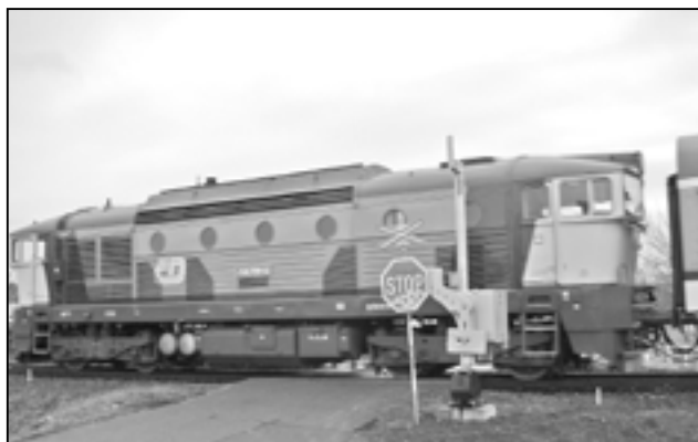
Lokomotiva 750.7 v čele rychlíku 701 „Buchlov“, který jede denně v trase Hradec Králové – Staré Město u Uh. Hrad. – Luhačovice. Bývalý stroj řady 754 s názvem „Brejlovec“ tak po svém znovuzrození a klasickým vzhledem ukrývá v podstatě novou lokomotivu.
