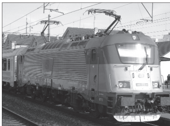
Elektrická lokomotiva Českých drah řady 380 je tryskatémová a její maximální rychlost je 200 km/hod. Výkon stroje je mimořádný – 7,2 MW. Můžeme si ji otestovat například při použití vlaků EuroCity mezi Starým Městem a Hodonínem. Úsek trati 34 km dlouhý dokáže projet za 15 minut.
